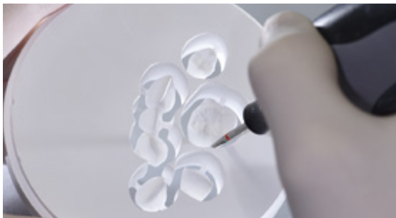
Heraustrennen der Restaurationen mit feinen Hartmetallfräsen oder diamantierten Schleifkörpern. Es empfiehlt sich die Haltestege einseitig einzukerben, bevor die Restauration komplett herausgetrennt wird.
