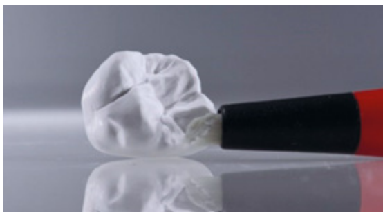
Zirkoniumoxidstaub mit einem weichen Pinsel sorgfältig reinigen und anschließend mit ölfreier Druckluft abblasen.
