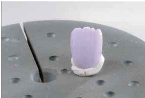
Zur Kristallisation die teilreduzierten IPS e.max CAD-Restaurationen mit IPS Object Fix Putty oder Flow direkt auf dem IPS e.max CAD Crystallization Tray platzieren.
