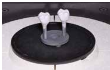
Max. zwei IPS e.max CAD HT-/MT-/LT-Einheiten auf dem IPS e.max CAD Speed Crystallization Tray im Ofen platzieren und mit dem Speed-Kristallisationsbrand brennen.
