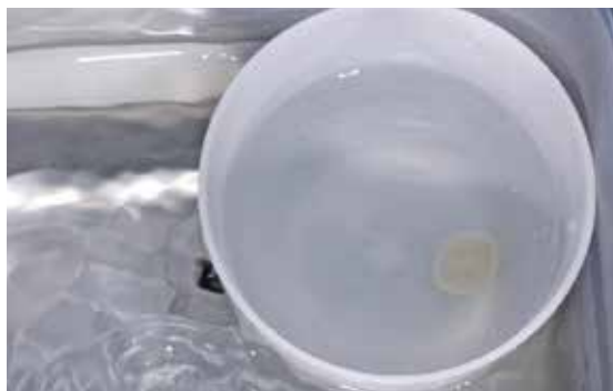
Anhaftende Rückstände mit Ultraschall im Wasserbad ...
