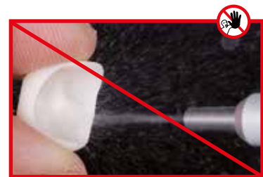
Rückstände nicht mit Al_2O_3 oder Glanzstrahlperlen abstrahlen.
