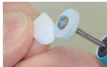
Ränder mit geeigneten Instrumenten überarbeiten.
