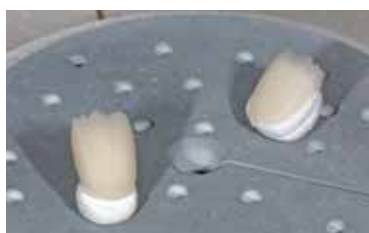
Nach Ablauf des Kristallisationsprogramms Brenngutträger aus dem Ofen nehmen und IPS e.max CAD-Restaurations auf Raumtemperatur abkühlen lassen.
