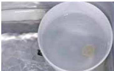
Anhaftende Rückstände mit Ultraschall im Wasserbad ...
