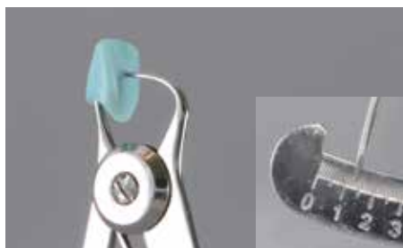
Manuelle Schichtstärkenbestimmung, zentral an der dünnsten vestibulären Stelle.
