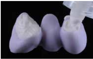
Die Kroneninnenseiten, der zuvor gereinigten Brücke mit IPS Object Fix Putty oder Flow auffüllen und den geeigneten IPS e.max CAD Crystallization Pin eindrücken. Brücke sofort auf den IPS e.max CAD Crystallization Tray platzieren.
