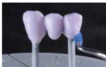
Verdrängtes IPS Object Fix Putty oder Flow mit Kunststoffspatel vom Rand zum Stützstift so glätten, dass der Stützstift stabil in der Paste fixiert und die Kronenränder exakt unterstützt sind.
