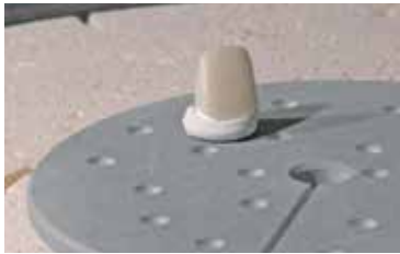
Nach Ablauf des Kristallisationsprogramms Brenngutträger aus dem Ofen entnehmen und IPS e.max CAD-Restauration auf Raumtemperatur abkühlen lassen.
