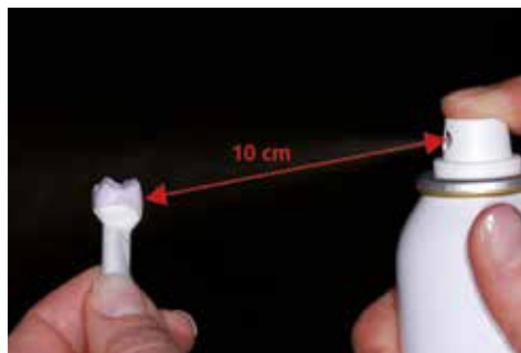
Restauration am IPS e.max CAD Crystallization Pin festhalten.
