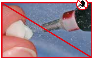
Rückstände nicht mit \text{Al}_2\text{O}_3 oder Glanzstrahlperlen abstrahlen.
